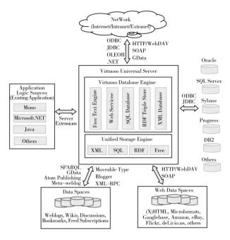
图 1 Virtuoso 系统架构<sup>[20]</sup>
