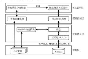
图 2 基于 Virtuoso 术语服务的系统架构
